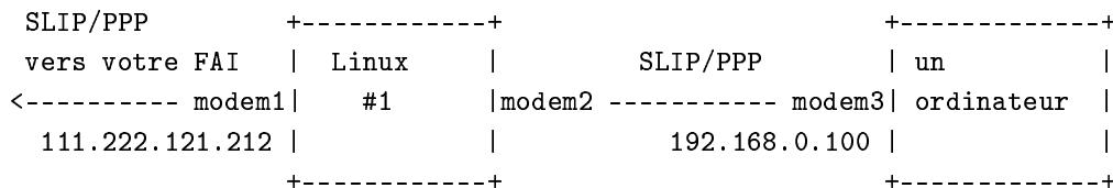
Sur le dessin ci-dessus, une machine Linux, Linux #1, avec IP\_MASQUERADING d'installé est connecté à Internet par le modem1 via SLIP/ou/PPP. Elle a une adresse IP publique :
