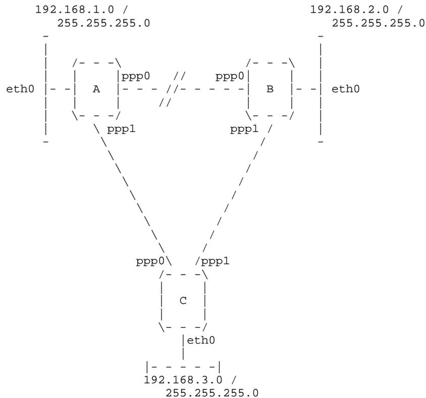
Nous avons trois routeurs A, B et C. Chacun supporte un segment Ethernet avec un réseau IP de classe C (masque de réseau 255.255.255.0). Chaque routeur a également une liaison PPP vers chacun des autres routeurs. Ce réseau forme un triangle.
